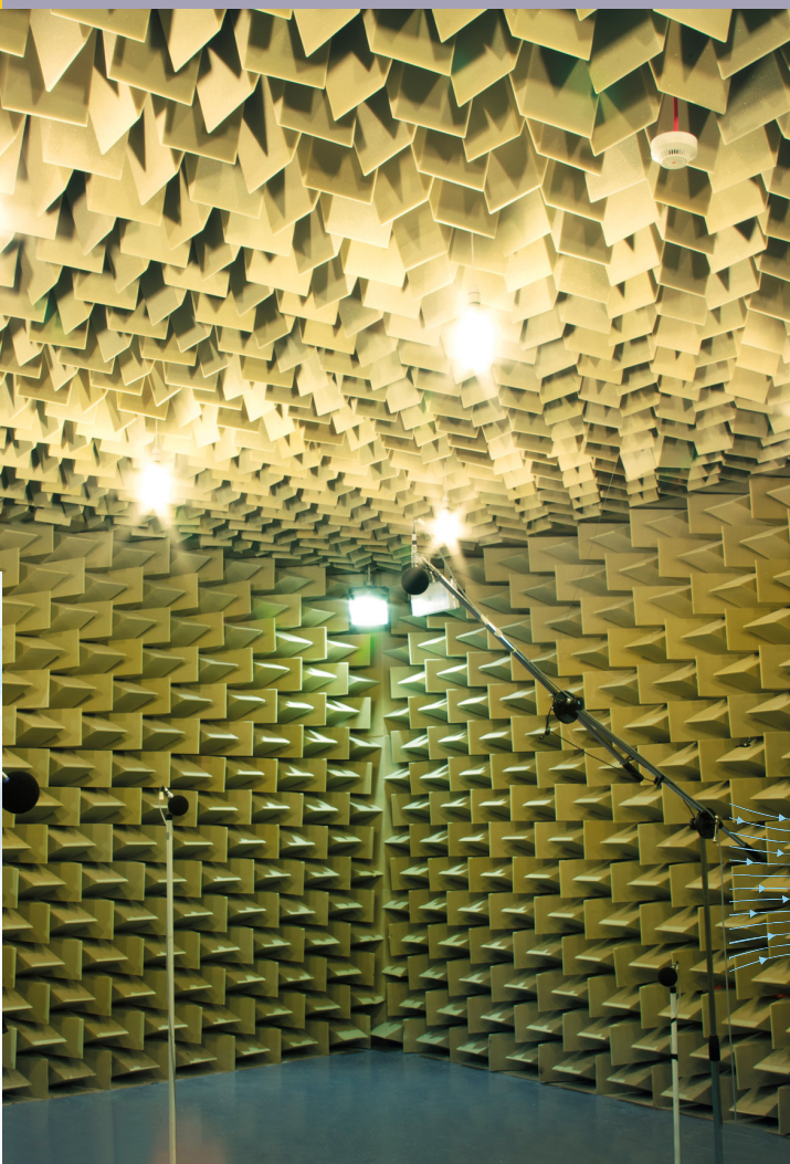
Ci-dessus, chambre anéchoïque dédiée aux tests sonores, dont les parois absorbent les ondes sonores ; à droite, étude du flux d'air du styler Air Wrap
